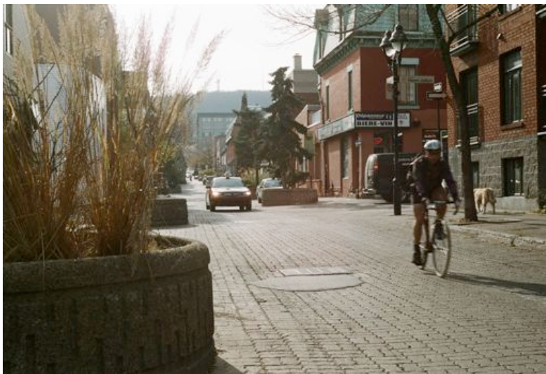
Bacs végétalisés servant à apaiser la circulation automobile, rue Duluth (Source: Christian Petit)
